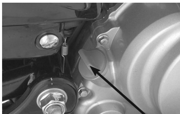
TAMPA DE ABASTECIMENTO DE ÓLEO/VARETA DE MEDIÇÃO
